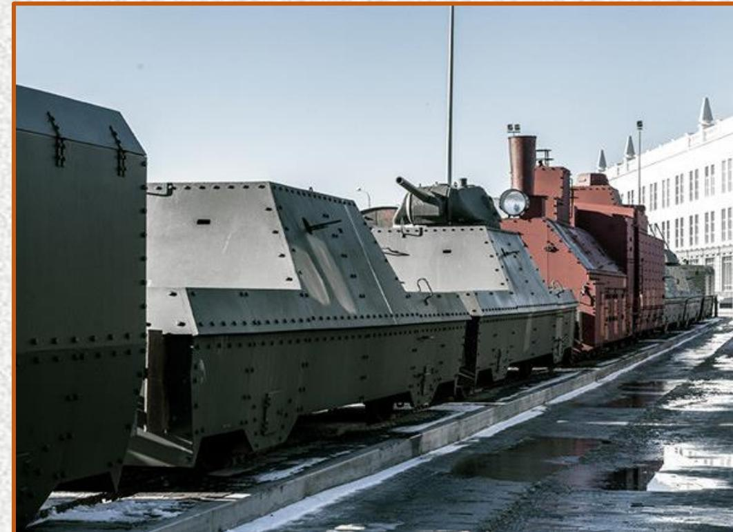
Каждый бронепоезд состоял из одетого в броню паровоза, четырёх бронированных платформ с орудиями, вагона-кухни и вагона для бойцов.
