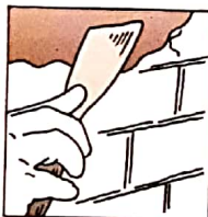
4. На материал наносится клей или используются другие типы крепления
